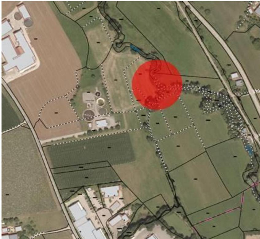
Abb. 4 Geplanter Einleitungsbereich des anfallenden Oberflächenwassers in die Isen
